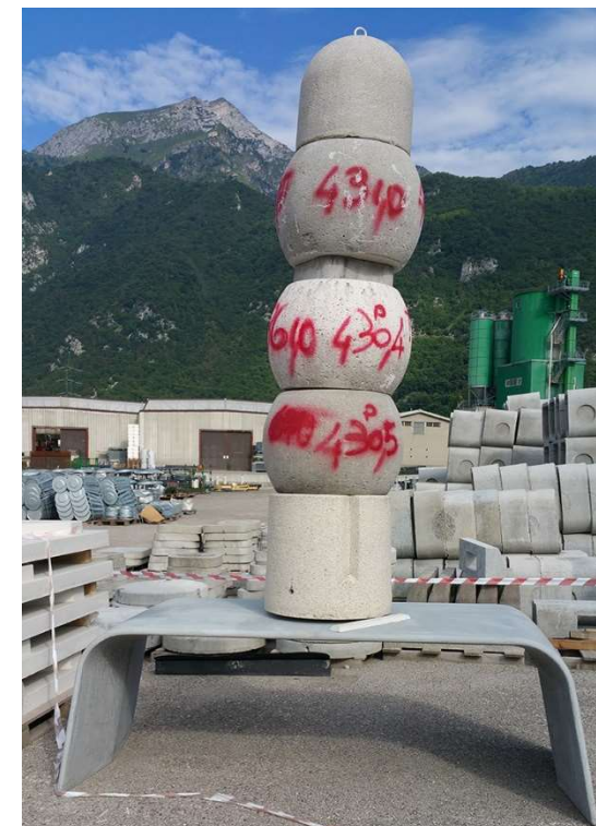
PROTOTIPO DI TAVOLO CARICATO CON 2000 KG DA OLTRE 30 GIORNI
